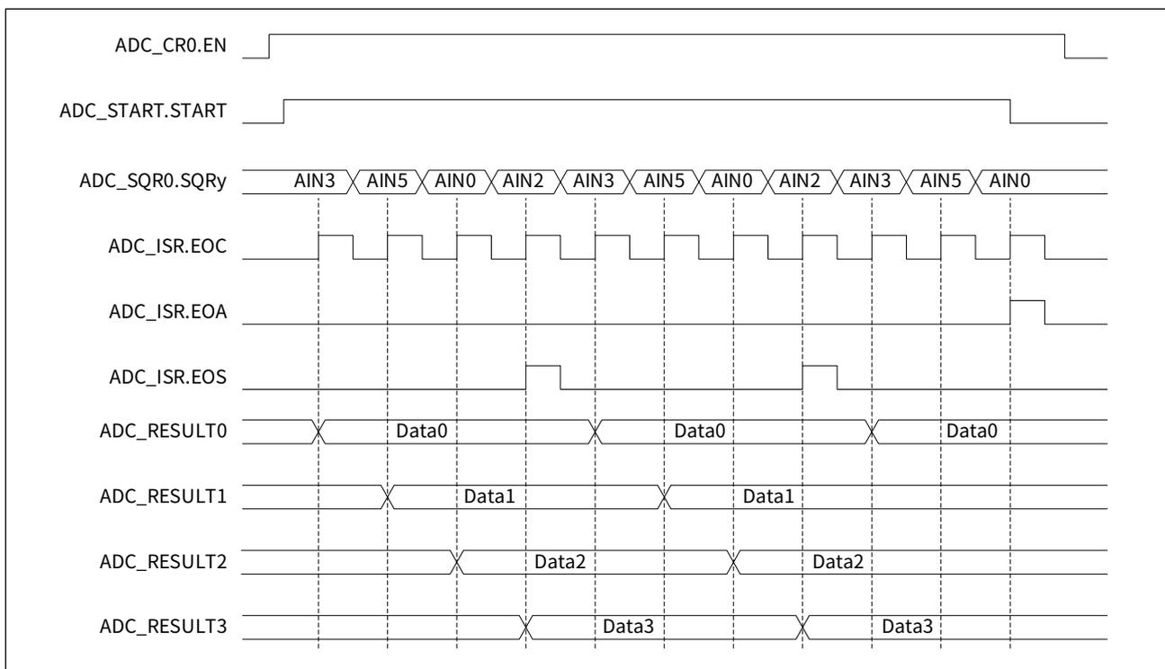
通过 START 位启动 ADC 序列多次转换，参考操作流程如下：
