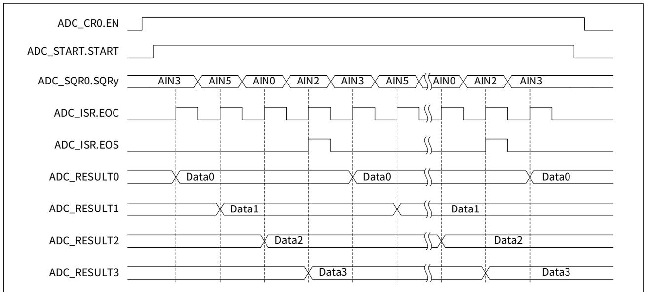
通过 START 位启动 ADC 序列连续转换，参考操作流程如下：
