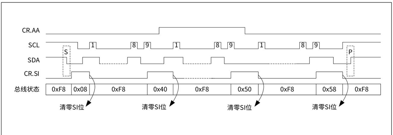
主机接收模式下数据接收流程图及状态寄存器值如下图所示：
