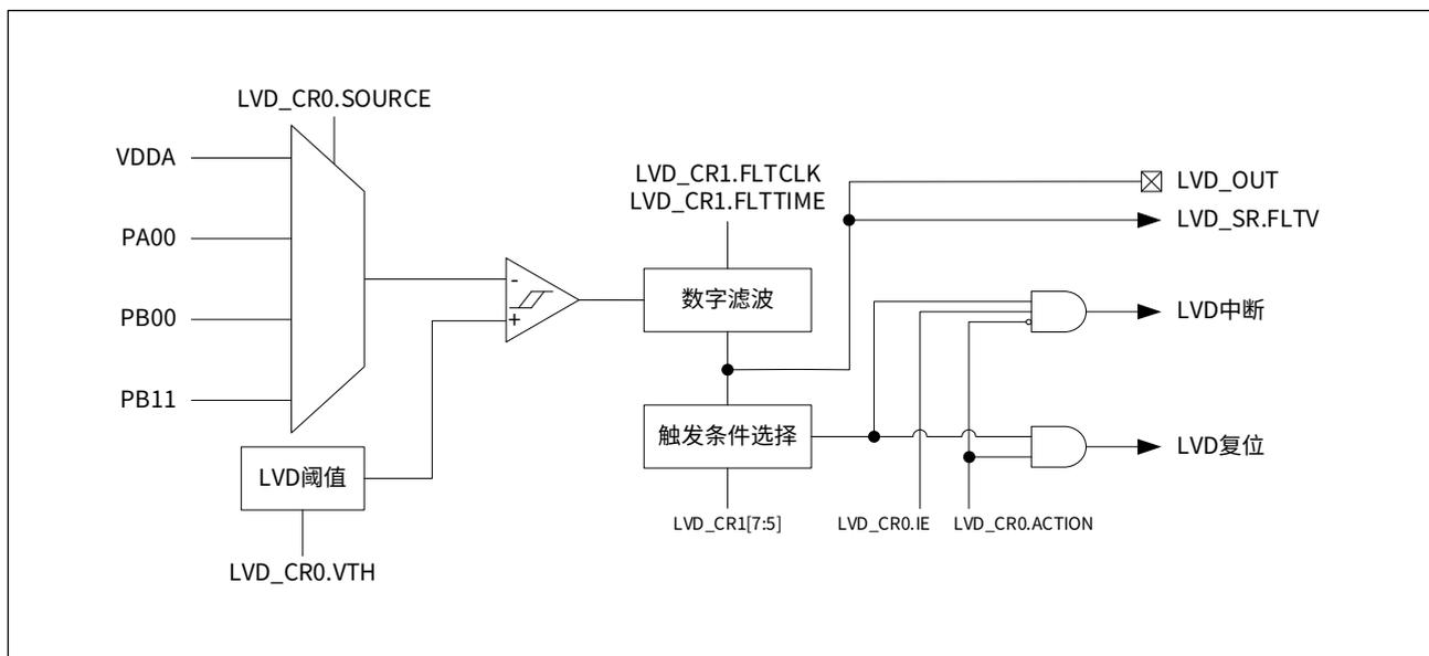
LVD 可以监测 VDDA 电源电压，也可监测外部引脚输入电压（PA00、PB00、PB11），具体通过控制寄存器 LVD\_CR0 的 SOURCE 位域来选择。当使用外部模拟信号输入时，用户必须将对应 GPIO 端口配置为模拟功能（GPIOx\_ANALOG.PINy = 1）。
