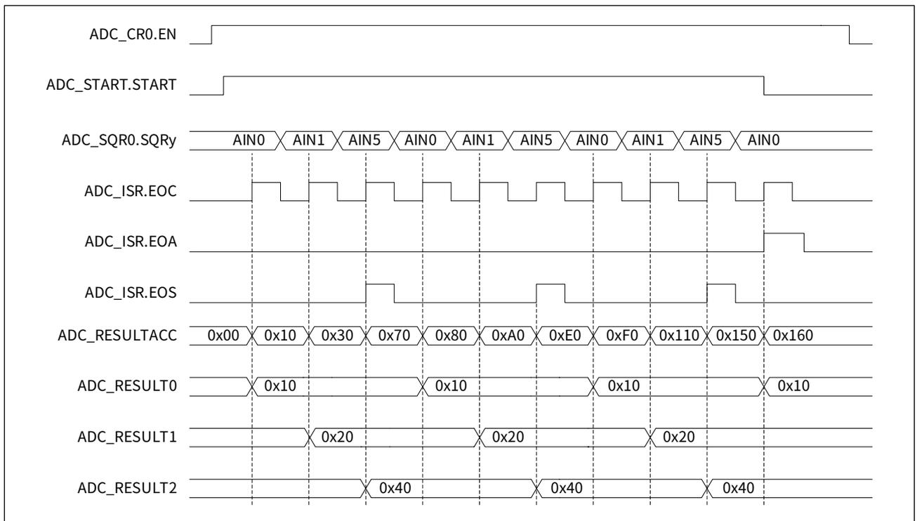
通过 START 位启动 ADC 序列多次转换，并对转换结果进行累加，操作流程如下：
