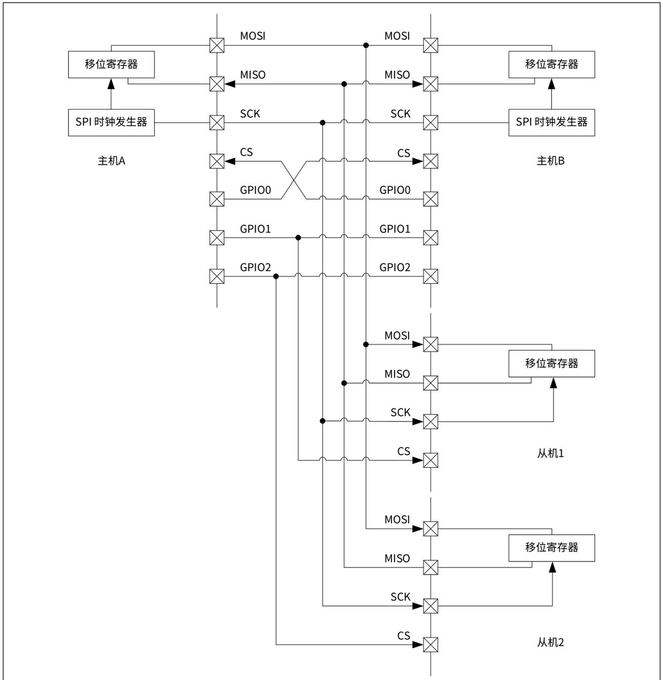
为保证多机通信模式下通信可靠性，从机的控制寄存器 SPIx\_CR1 的 MISOHD 位域应设置为 1，当从机被选中时，MISO 引脚为 CMOS 输出；未被选中时，MISO 引脚为高阻输出。
