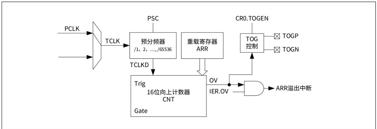
在实际应用中，系统时钟 PCLK 的频率是已知的，通过合理设置预分频器系数 PSC 可以对固定时长的时钟进行计数，配合对重载值 ARR 的设置及计数器 ARR 溢出中断标志位的使用，可以精确获得某一特定时长，从而达到定时的目的。下图是定时器在连续计数模式下的定时波形：
