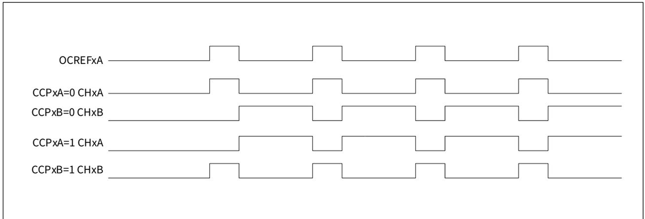
图 16-29 带有死区插入的互补 PWM 输出波形
