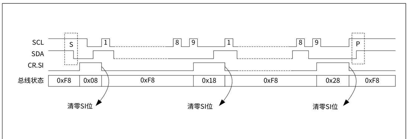
主机发送模式下数据发送流程图及状态寄存器值如下图所示：
