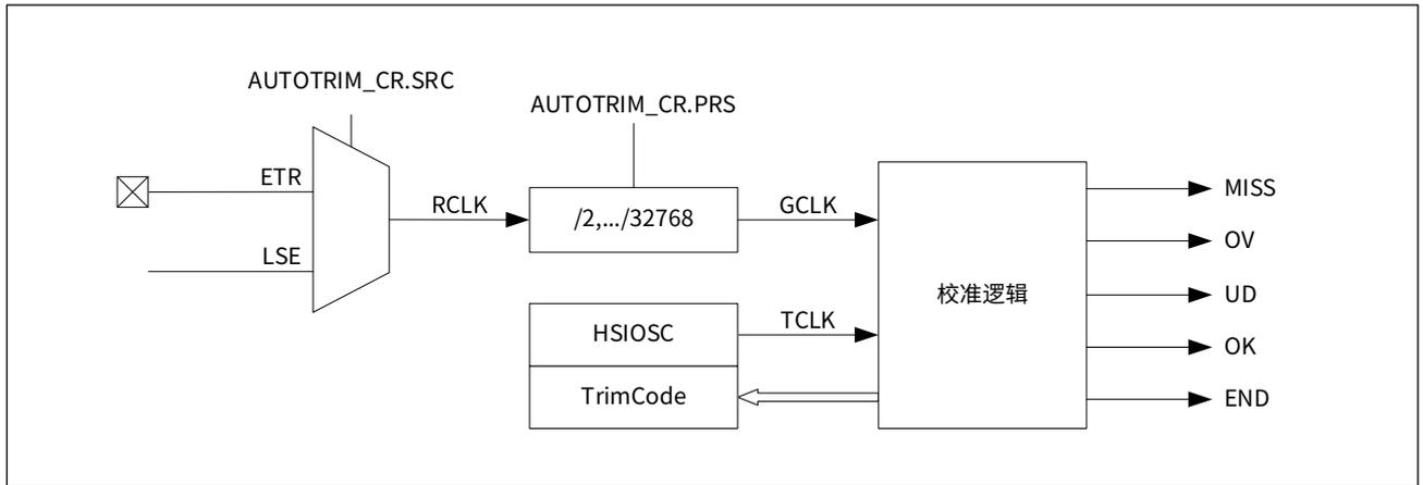
设置 AUTOTRIM\_CR.AUTO 为 1 使能自动校准，设置 AUTOTRIM\_CR.EN 为 1 使能定时器，开始自动校准流程。
