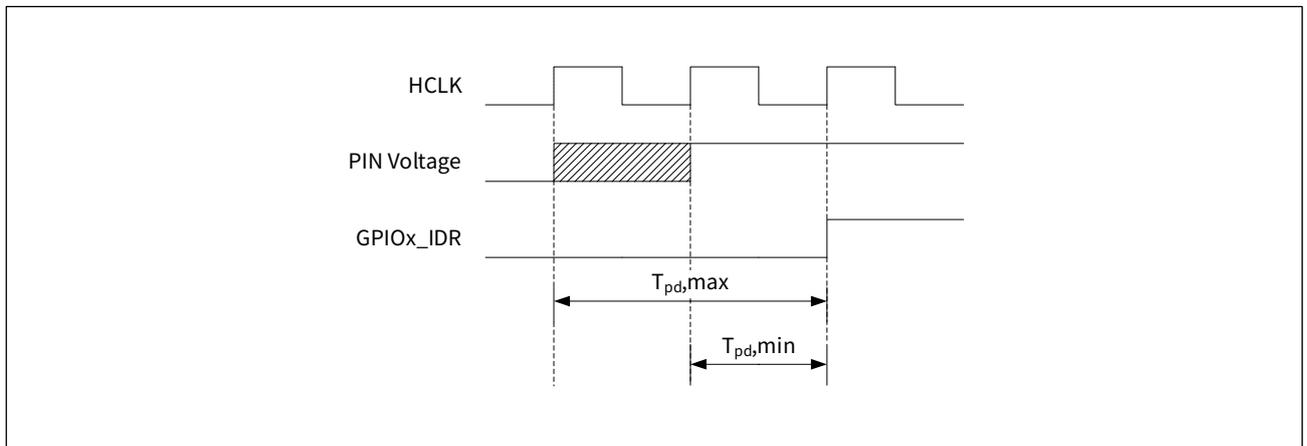
在系统时钟上升沿之后的时钟周期，引脚电平信号会锁存在内部寄存器，如图中阴影部分所示，在下一次系统时钟上升沿之后，稳定的引脚电平信号被读取，再一个系统时钟上升沿时，数据被锁存到 GPIOx\_IDR 寄存器中。信号延迟  $T_{pd}$  为 1~2 个系统时钟。
