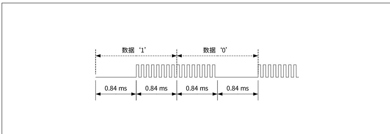
UART 调制是一种比较简单的红外调制方式，直接将串行数据与载波信号进行 ‘与’ 或 ‘或’ 运算。当 UART 串行波特率低于载波频率时，参考示意图如下图所示：
