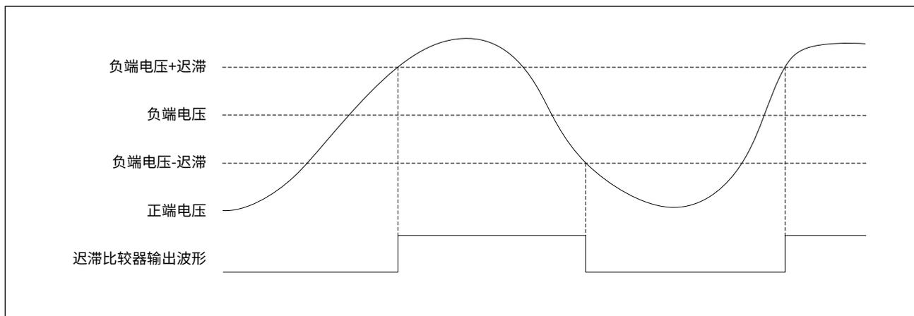
迟滞功能可以有效增强芯片的抗干扰能力，避免因输入信号的小幅度抖动，导致比较器的输出端不必要的频繁翻转。
