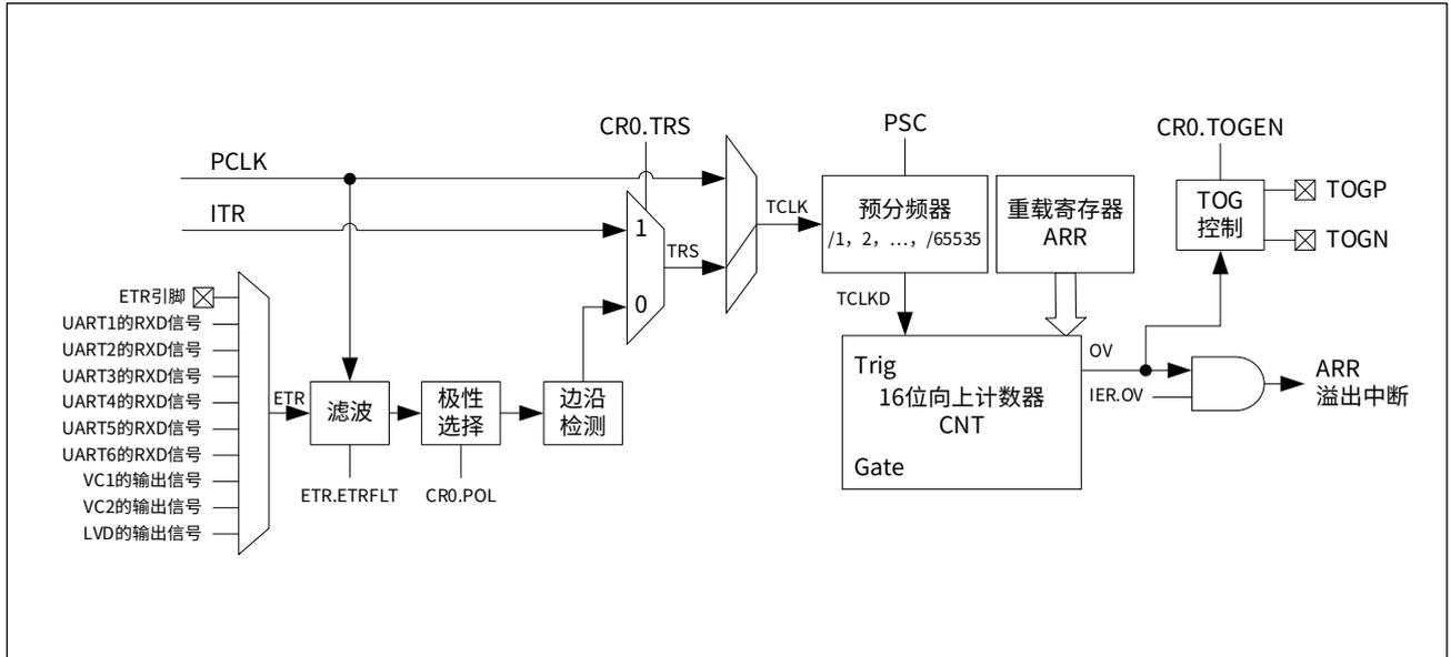
当设置控制寄存器 GTIMx\_CR0 的 EN 位域为 1 后，计数器对分频后的 TCLKD 信号累加计数，计数到 ARR 值后产生溢出，并重新从 0 开始计数。计数器模式的具体寄存器配置流程请参见 15.6 编程示例。
