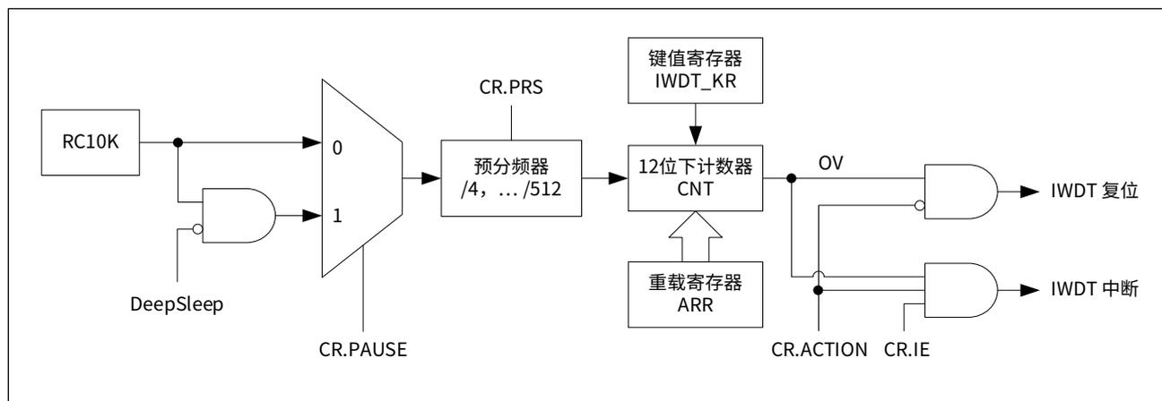
IWDT 由一个 12 位可重载的向下计数器实现，其计数时钟源为内部专用低速 RC 振荡器 RC10K，通过控制寄存器 IWDT\_CR 的 PRS 位域可对其时钟源 RC10K 信号进行 4 ~ 512 的预分频。IWDT 计数器发生溢出时可选择产生中断和复位信号。
