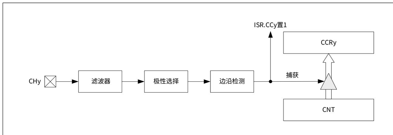
各个通道上触发捕获的条件由比较捕获控制寄存器 GTIMx\_CMMR 决定，参见下表：
