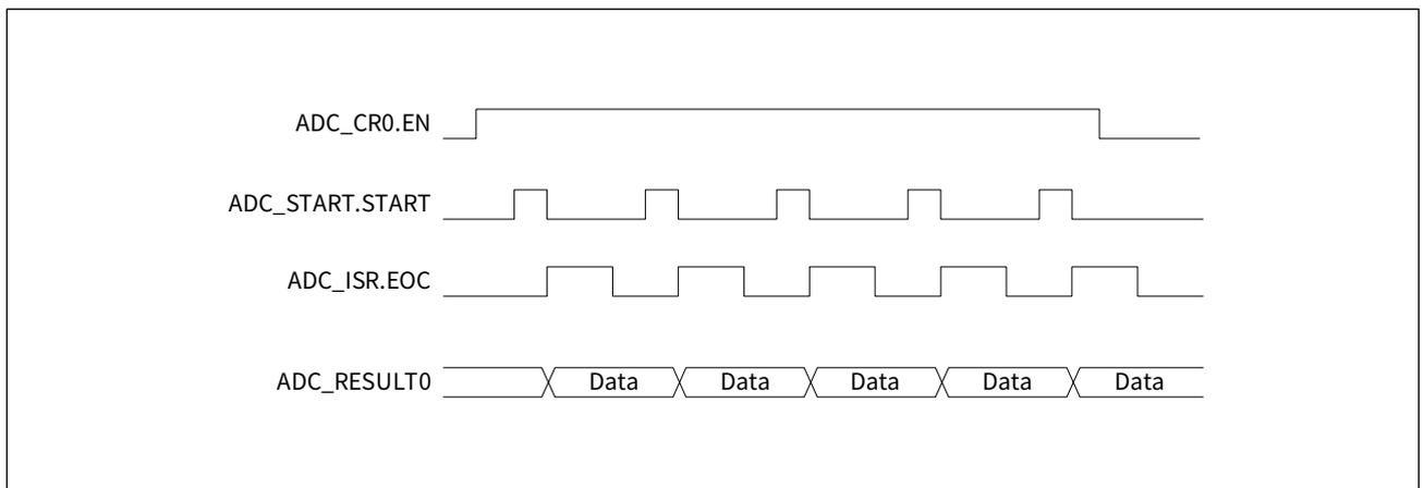
通过 START 位启动 ADC 单通道对外部模拟输入信号的单次转换，参考操作流程如下：
