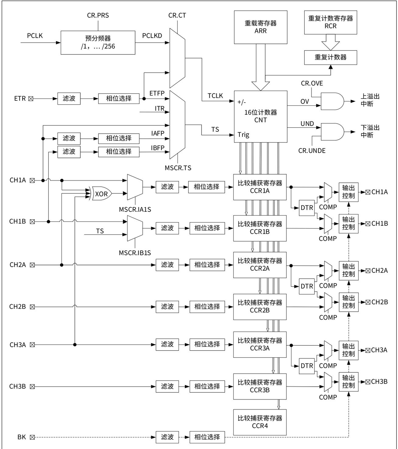
通过 16 位计数器和 7 路比较单元的结合，可以实现输入捕获、输出比较的功能，可以用来测量输入信号的脉宽、周期，可以输出 PWM 波形。
