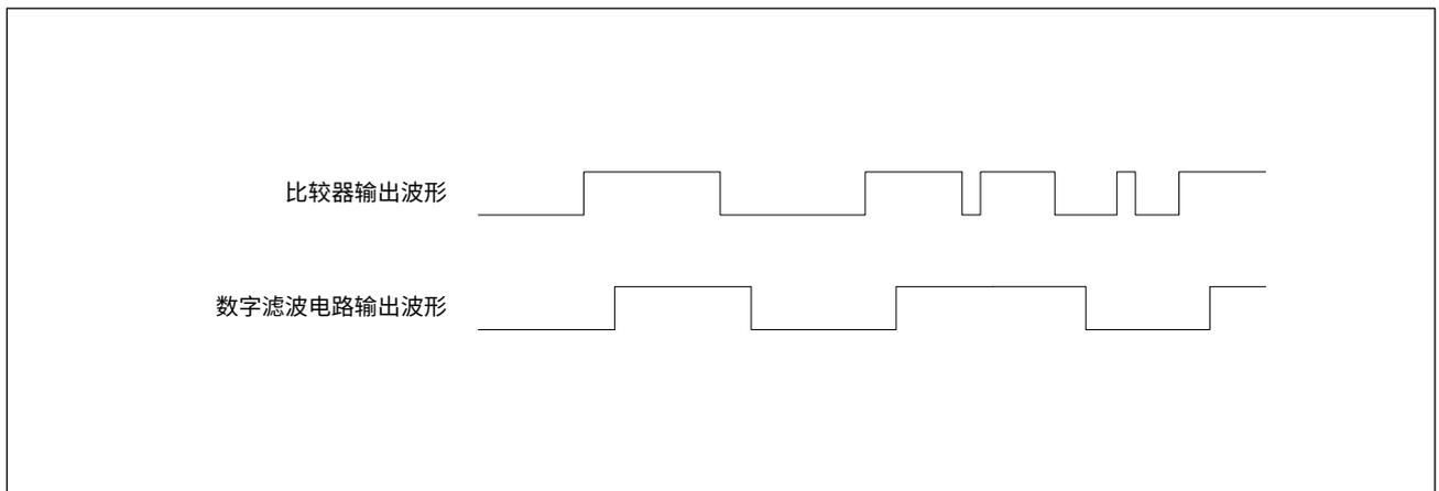
电压比较器的输出可以作为高级定时器 (ATIM) 的 BK 刹车输入或 OCREF\_CLR 输入，分别由控制寄存器 VCx\_CR1 的 ATIMBK 和 ATIMCLR 位域控制，关于 BK 和 OCREF\_CLR 的详细介绍请参见 [16 高级定时器 \(ATIM\)](#) 章节。此功能通常应用于电机保护场合，详细请参考相关应用笔记。
