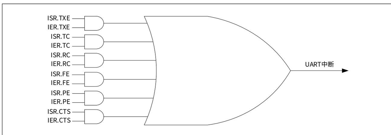
在用户 UART 中断服务程序中，应查询相关 UART 中断标志位，以进行相应的处理，在退出中断服务程序之前，要清除该中断标志位，避免重复进入中断程序。
