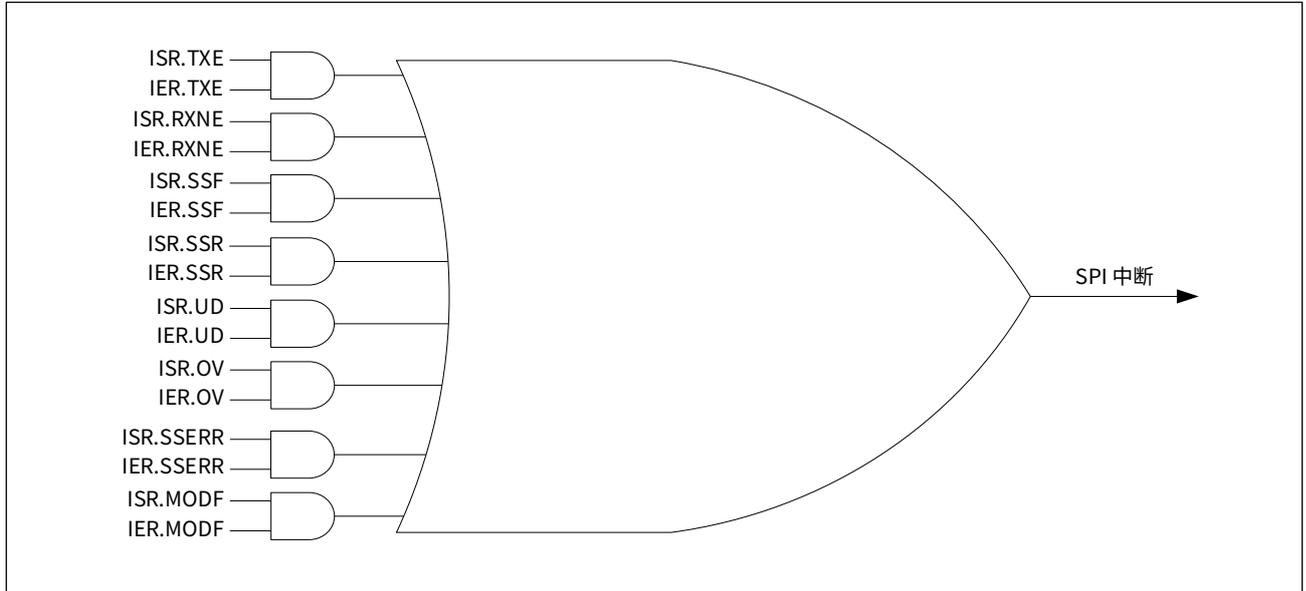
在用户 SPI 中断服务程序中，应查询相关 SPI 中断标志位，以进行相应的处理，在退出中断服务程序之前，要清除该中断标志位，避免重复进入中断程序。
