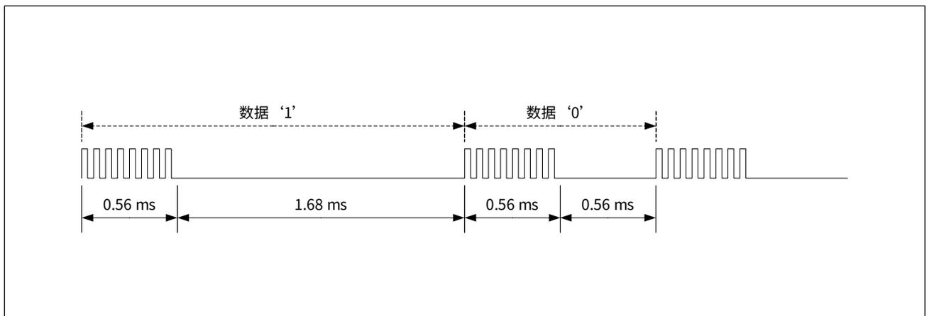
PPM 脉冲位置调制，以发射载波的位置表示 ‘0’ 和 ‘1’。从发射载波到不发射载波为 ‘0’，从不发射载波到发射载波为 ‘1’。比如 SAA3010，载波发射 0.84ms，不发射 0.84ms，表示 ‘0’；不发射 0.84ms，载波发射 0.84ms，表示 ‘1’。参考示意图如下图所示：
