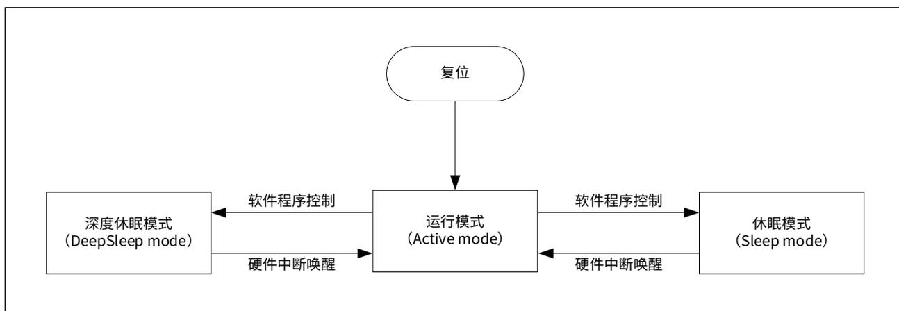
运行模式下 CPU 正常运行，所有模块用户均可正常使用。休眠模式下，CPU 停止运行，所有外设不受影响，所有 I/O 引脚保持状态不变。深度休眠模式下，CPU 停止运行，高速时钟 (HSE、HSIOSC) 自动关闭，低速时钟 (LSE、LSI、RC10K、RC150K) 保持原状态不变。
