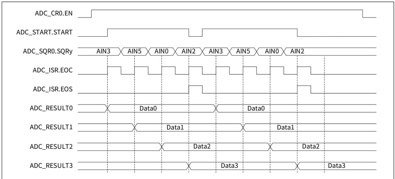
通过 START 位启动 ADC 序列扫描转换，参考操作流程如下：
