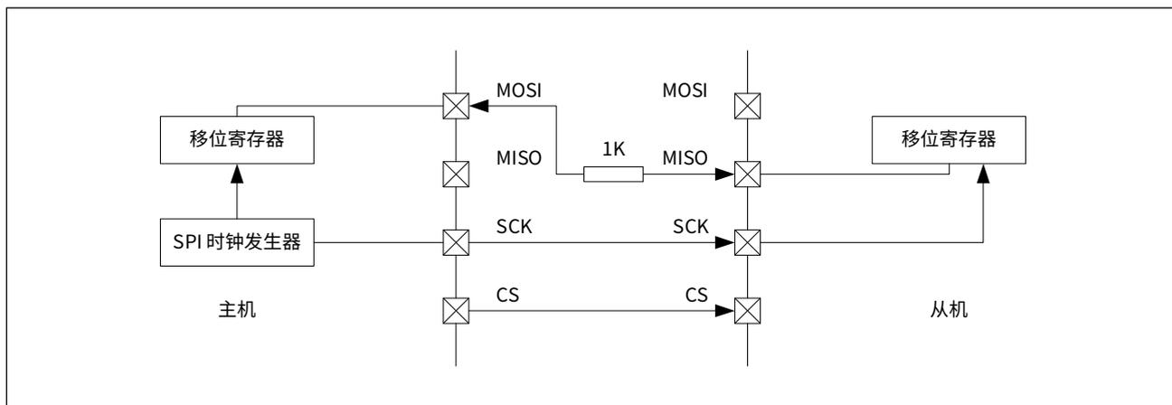
单线半双工通信时，由于主机和从机的通信方向无法保证同步切换，有可能会驱动冲突而导致器件损坏，建议在主机和从机之间的数据线上串联一个电阻，以限制电流。
