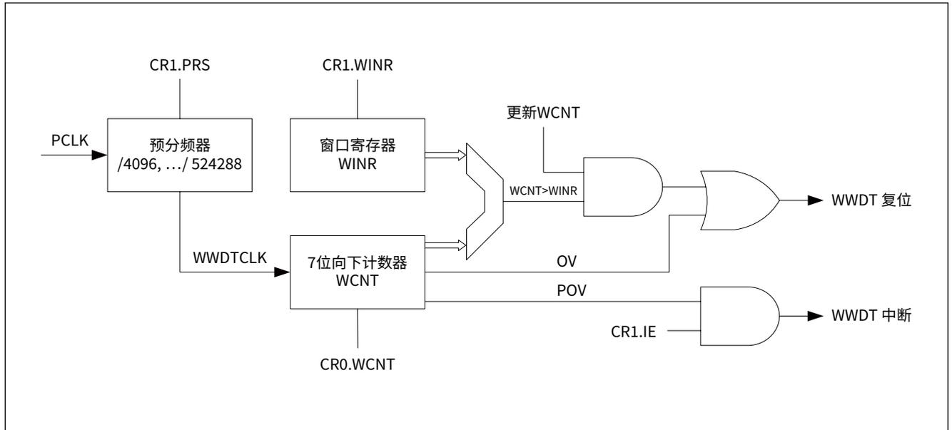
WWDT 内含一个 7 位递减计数器，计数时钟源为内部系统时钟 PCLK，通过控制寄存器 WWDT\_CR1 的 PRS 位域可对其时钟源 PCLK 进行分频，分频后得到计数时钟 WWDTCCLK 用来驱动计数器计数。
