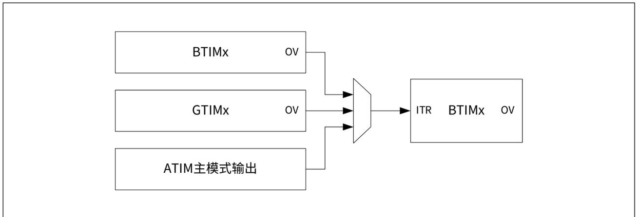
级联使用时，第一级定时器的计数时钟源可以是 PCLK 或外部 ETR 引脚输入的信号，后级定时器的计数时钟源为前一级定时器的 ARR 溢出信号 OV 或高级定时器 (ATIM) 的主模式输出信号。
