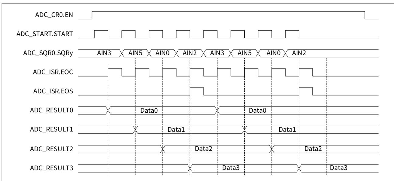
通过 START 位启动 ADC 序列断续转换，参考操作流程如下：
