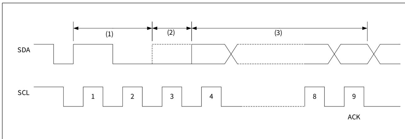
1. 在阶段（1），A 主机和 B 主机均先后发送逻辑 1 和逻辑 0，由于数据相同且同步，2 个主机都不会检测到总线冲突。
