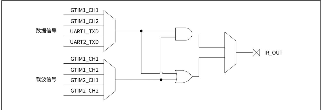
IR 红外调制控制寄存器 SYSCTRL\_IRMOD，用于选择载波信号和数据信号的来源，以及二者的‘与’‘或’操作。选择‘与’‘或’由用户的硬件红外发射管的驱动电平决定。
