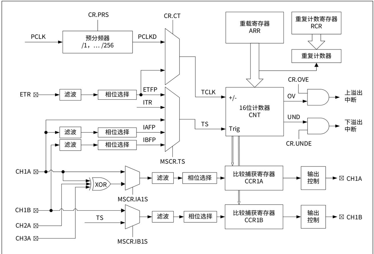
CH1A、CH1B 输入信号具有滤波功能，分别由 ATIM\_FLTR 寄存器的 OCM1AFLT1A 和 OCM1BFLT1B 位域设置；可配置相位，分别由 ATIM\_FLTR 寄存器的 CCP1A 和 CCP1B 位域控制。
