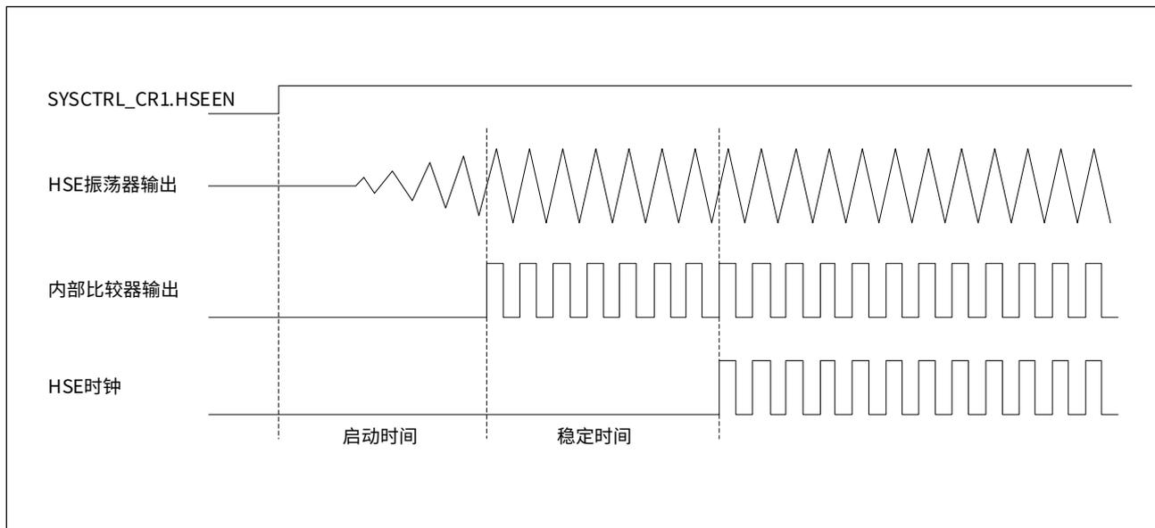
当设置 `SYSCTRL_CR1.HSEEN` 为 1 后，HSE 时钟振荡电路开始工作，但此时输出的时钟信号振幅很小。经过启动时间阶段后，输出时钟信号的振幅、占空比等可满足内部采样电路需求，进入稳定时间阶段。在稳定时间阶段，芯片内部时钟监控电路对 HSE 输出的时钟信号进行计数，当计数值达到设定的个数后，认为 HSE 时钟信号已稳定，HSE 时钟稳定标志位 `SYSCTRL_HSE.STABLE` 被置 1；如果在一定时间内未检测到 `SYSCTRL_HSE.WAITCYCLE` 个时钟信号则认为 HSE 振荡器起振失败。
