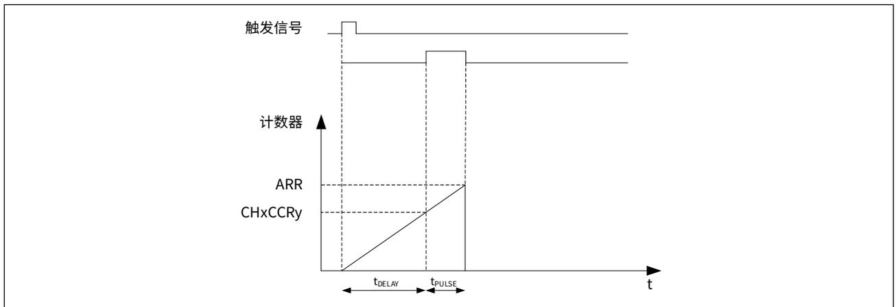
以从模式触发启动定时器后，定时器在检测到触发信号的有效边沿时开始计数，延迟  $t_{DELAY}$  之后，在比较输出端口上产生一个宽度为  $t_{PULSE}$  的正脉冲。其中  $t_{DELAY}$  由计数寄存器 ATIM\_CNT 的初值和比较捕获寄存器 ATIM\_CHxCCRy 的差值确定， $t_{PULSE}$  由重载寄存器 ATIM\_ARR 和比较捕获寄存器 ATIM\_CHxCCRy 来确定。
