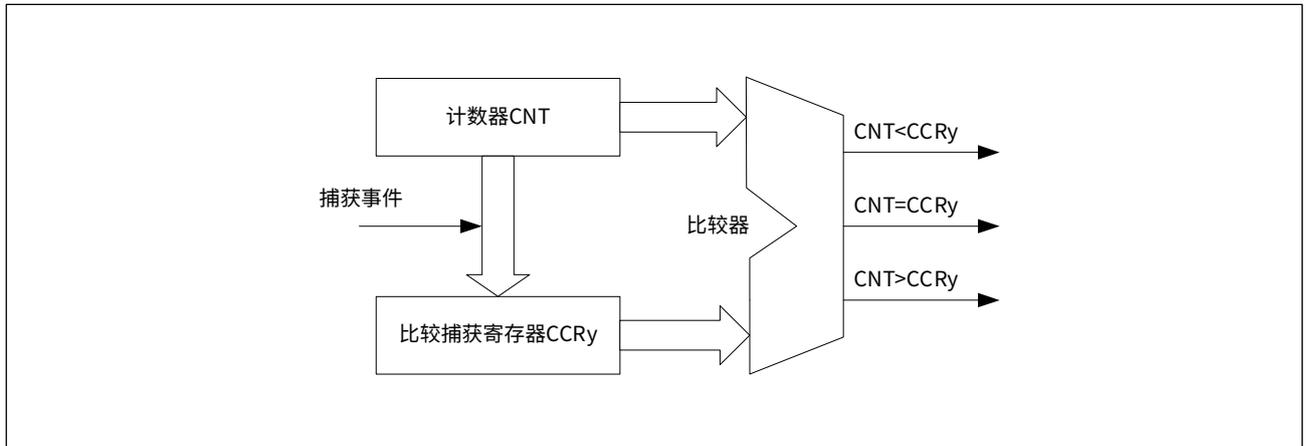
当进行输入捕获时，一旦相应的通道有捕获事件发生，计数器 CNT 的当前值立即传入比较捕获寄存器 CCRy 中保存，如果对应的捕获比较中断使能，将产生一个中断请求。
