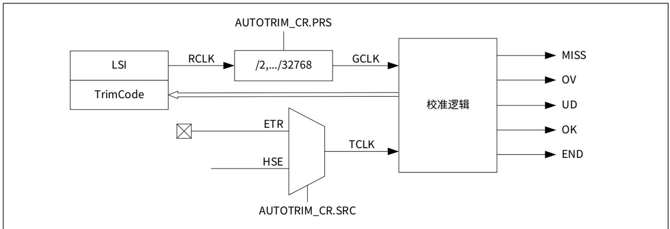
设置 AUTOTRIM\_CR.AUTO 为 1 使能自动校准，设置 AUTOTRIM\_CR.EN 为 1 使能定时器，开始自动校准流程。
