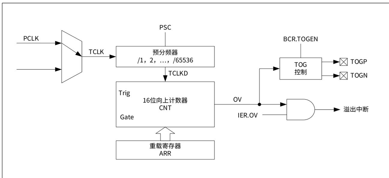
设置 BTIMx\_BCR.MODE 为 0x00，使 BTIMx 工作于定时器模式。设置 BTIMx\_BCR.EN 为 1 使能 BTIMx，计数器 CNT 将在计数时钟 TCLKD 的驱动下累加计数。当计数值到达重载值 ARR 后产生溢出，计数器 ARR 溢出标志位 BTIMx\_ISR.OV 被硬件置位，如果允许中断（设置中断使能寄存器 BTIMx\_IER.OV 为 1），CPU 将响应中断服务程序。退出中断服务程序之前，应设置中断标志清除寄存器 BTIMx\_ICR.OV 为 0 以清除该标志。
