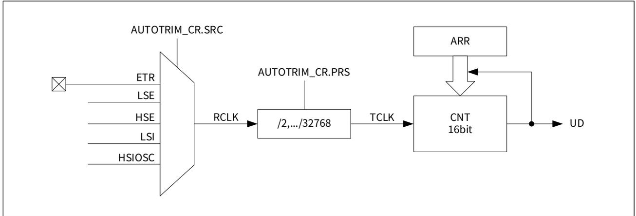
该模式下可选 5 种计数器时钟源 RCLK：LSE/HSE/LSI/HSIOSC 以及外部 AUTOTRIM\_ETR 引脚输入的 ETR 信号，通过控制寄存器 AUTOTRIM\_CR 的 SRC 位域来选择。时钟源经预分频器分频后作为计数器时钟，通过 AUTOTRIM\_CR 寄存器的 PRS 位域选择具体的分频系数。
