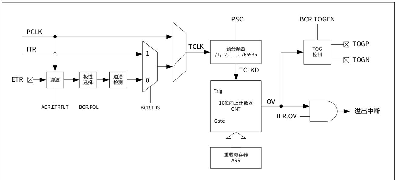
设置 BTIMx\_BCR.MODE 为 0x01，使 BTIMx 工作于计数器模式。设置 BTIMx\_BCR.EN 为 1 使能 BTIMx，计数器 CNT 对分频后的 TCLKD 信号进行累加计数。当计数值到达重载值 ARR 后产生溢出，计数器 ARR 溢出标志位 BTIMx\_ISR.OV 被硬件置位，如果允许中断（设置中断使能寄存器 BTIMx\_IER.OV 为 1），CPU 将响应中断服务程序。退出中断服务程序之前，应设置中断标志清除寄存器 BTIMx\_ICR.OV 为 0 以清除该标志。
