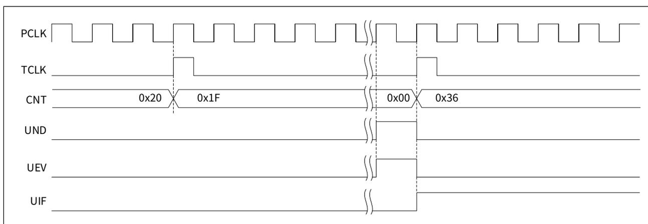
图 16-12 向下计数，当没有使用重载缓存使能的更新事件
