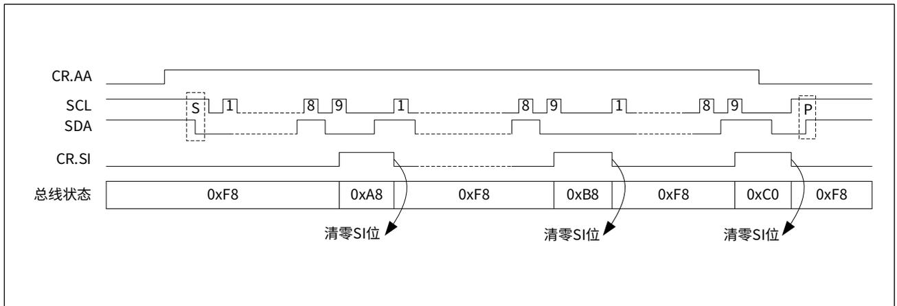
从机发送模式下数据发送流程图及状态寄存器值如下图所示：
