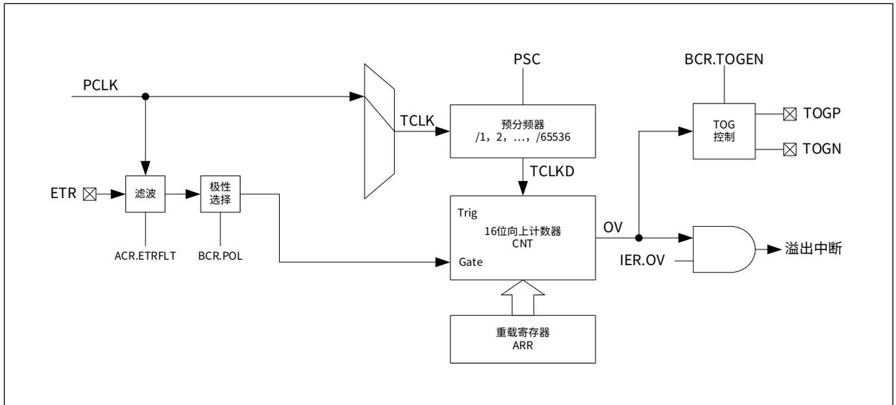
计数器启动后，计数器从初始值开始向上计数，当计数值到达重载值 ARR 后产生溢出，计数器 ARR 溢出标志位 BTIMx\_ISR.OV 被硬件置位，如果允许中断（设置中断使能寄存器 BTIMx\_IER.OV 为 1），CPU 将响应中断服务程序。退出中断服务程序之前，应设置中断标志清除寄存器 BTIMx\_ICR.OV 为 0 以清除该标志。
