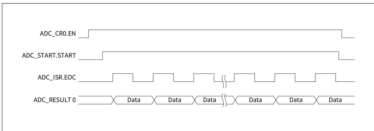
通过 START 位启动 ADC 单通道连续转换，参考操作流程如下：
