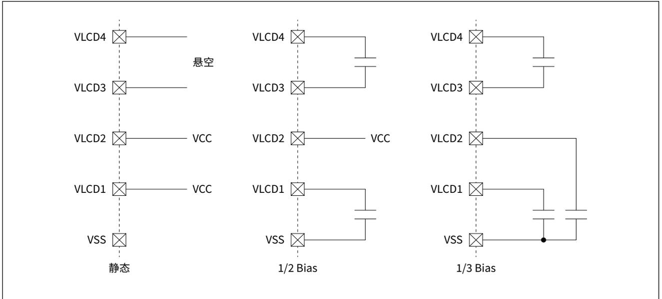
使用外部电容分压模式时, 驱动 LCD 屏的能力较强, 推荐使用 100nF 的电容。同时, 需要通过设置 LCD\_CR0 寄存器的 BUMP 位为 1, 使能电荷泵模式, 并设置 LCD\_CR0 寄存器的 CPCLK 位域, 选择合适的电荷泵工作频率。如果不使用外部电容分压模式, 必须将 LCD\_CR0 寄存器的 BUMP 位设置为 0, 关闭电荷泵。
