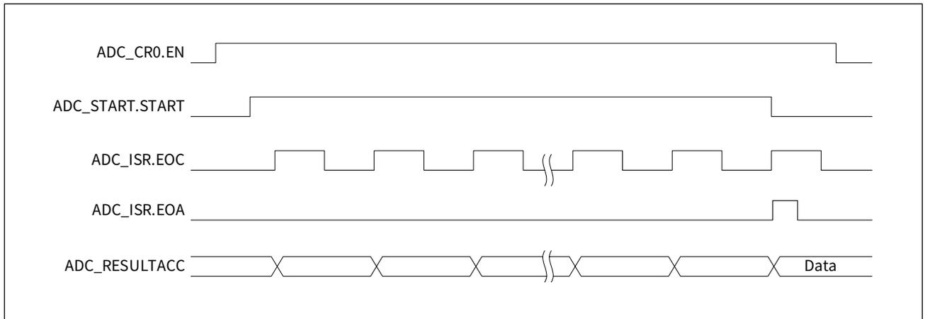
通过 START 位启动 ADC 单通道多次转换，参考操作流程如下：
