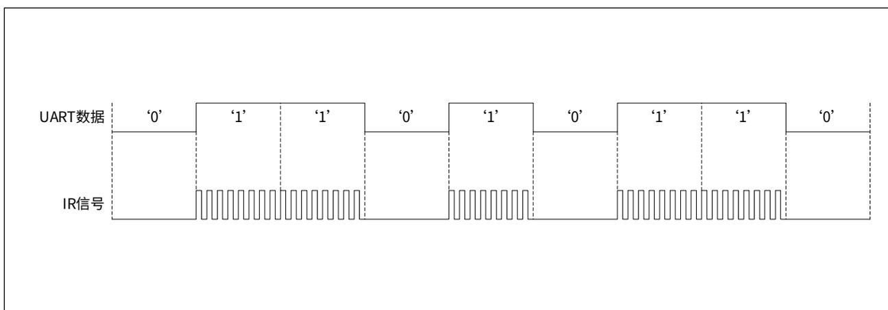
当 UART 串行波特率高于载波频率时，载波脉冲宽度应设置为位宽度的 3/16，载波频率需保持与串行频率一致。比如当 UART 波特率设置为 115.2Kbps 时，载波频率也设置为 115.2kHz，载波脉冲的宽度为 1.63μs ( $3/16 \times 1/115200\text{Hz} = 1.63\mu\text{s}$ )，参考示意图如下图所示：
