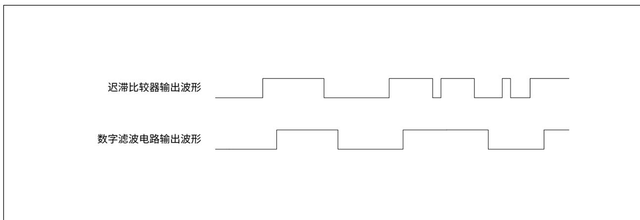
设置控制寄存器 LVD\_CR1 的 FLTEN 位域为 1，使能数字滤波模块。控制寄存器 LVD\_CR1 的 FLTCLK 位域用于选择数字滤波的时钟：
