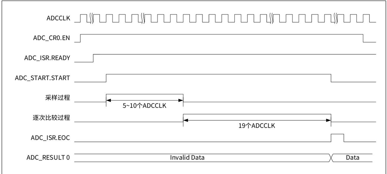
向 ADC 控制寄存器 ADC\_CR0 的 EN 位域写入 1，使能 ADC 模块。
