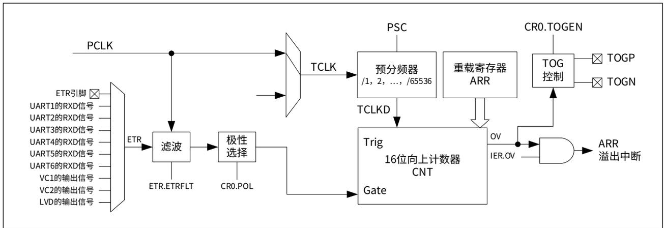
下图用于说明在门控模式下，当门控电平为无效电平时，即使 GTIMx\_CR0.EN 设置为 1，计数器也不会进行计数，只有当门控电平为有效电平时，计数器才进行计数，一旦门控电平失效，则立即暂停计数。
