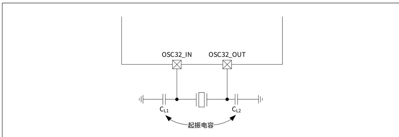
石英晶体 / 陶瓷谐振器和起振电容须尽可能靠近芯片振荡器引脚放置，使得振荡器输出失真和启动时间达到最小。起振电容取值大小须根据所选择的石英晶体 / 陶瓷谐振器进行调整，计算方法为：
